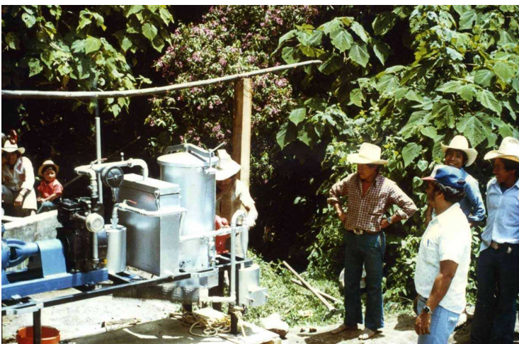
Abb. 4: Holzkohle-Gasgenerator mit Wasserpumpe, Motorleistung 2 kW (Guatemala 1985)
