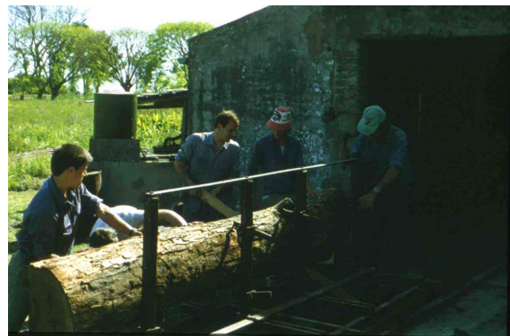
Abb.13 und 14: Gewerbliche Nutzung eines Holzvergasers in Ferrozement-Bauweise zum Antrieb des Motors einer Sägemühle, Leistung 20 kW (Argentinien 1992)
