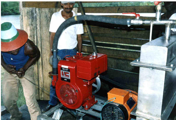
Abb.28: Der 530 ccm Einzylinder Motor wird mit Keilriemen mit dem Elektrogenerator verbunden. Rechts oben im Bild der Gas-Luft-Mischer.
