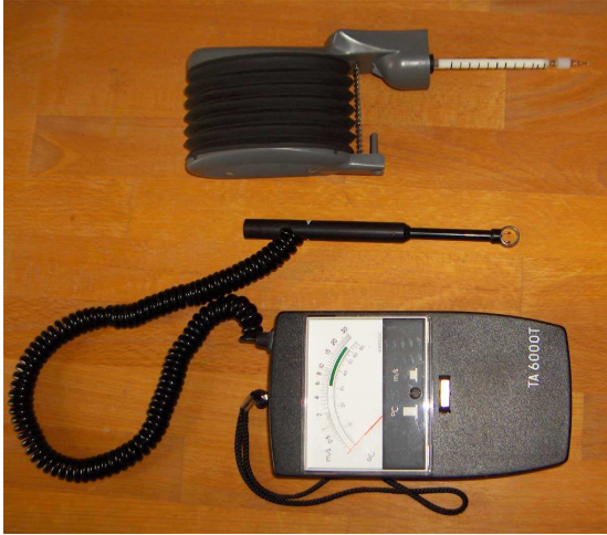
Abb.30: Pumpe mit Messröhrchen (oben) und Hitzdraht-Messinstrument
