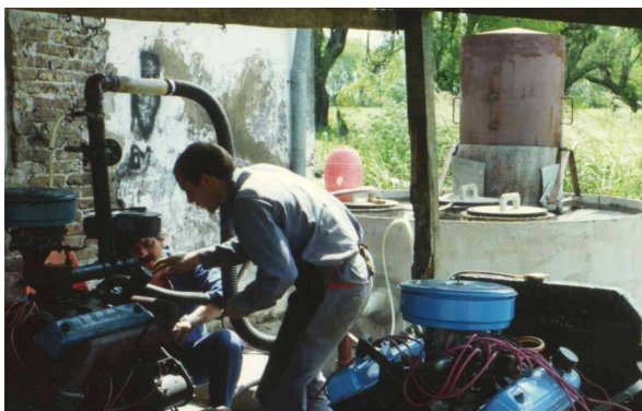
Abb.13 und 14: Gewerbliche Nutzung eines Holzvergasers in Ferrozement-Bauweise zum Antrieb des Motors einer Sägemühle, Leistung 20 kW (Argentinien 1992)
